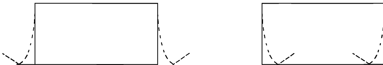
Рисунок 14 — Потеря устойчивости сечения простой формы
